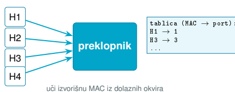
Figure 8.6: Samoučeći preklopnik gradi tablicu MAC → port iz izvorišnih adresa.
